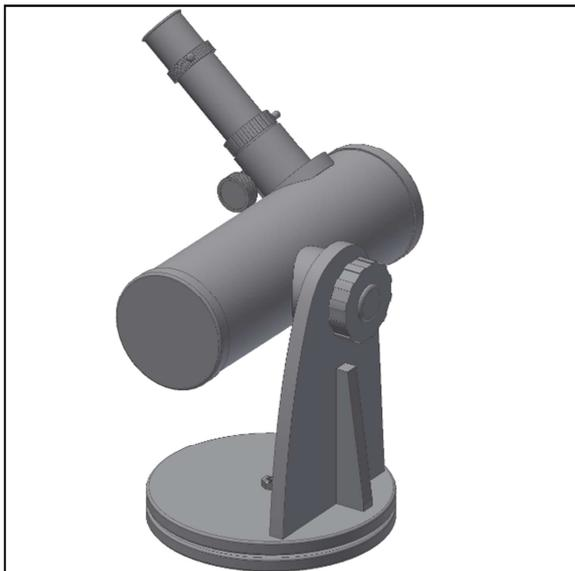
Nutzen Sie das Teleskop auf einem Tisch oder einer erhöhten Basis. Das macht Ihre Beobachtung deutlich komfortabler und es bringt mehr Spaß. Versuchen Sie verschiedene Okulare und Zubehörkombinationen (beachten Sie dazu Seite 5). Wenn im Azimut (rechts, links) die Friktion eingestellt werden muss, lösen oder ziehen Sie die Zentralmutter (Abb. 3) mit einem Mutternschlüssel (nicht im Lieferumfang) an.
